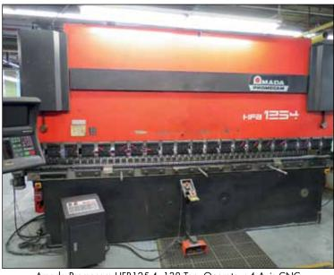
Amada Promecam HFB125-4, 138 Ton, Operateur 4 Axis CNC
